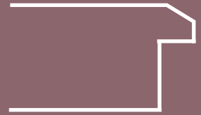
LK-4 (Facettenkante mit Bandbetonung)
